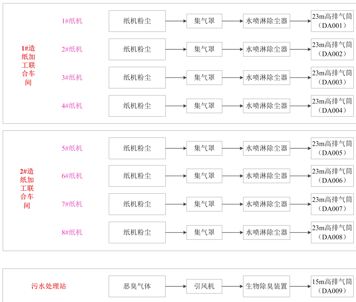
图 6.2-1 本项目废气收集及处理汇总示意图
