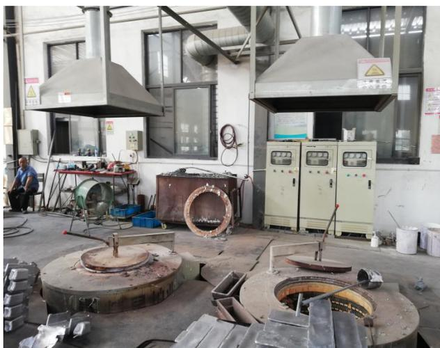
图 3.8-1 铝锭熔化炉
