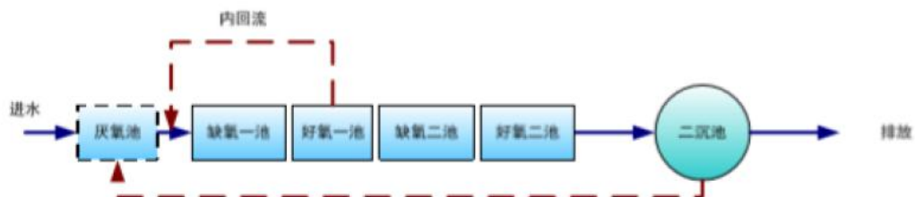
图 3.5-4 改良 bardenpho 工艺流程图
