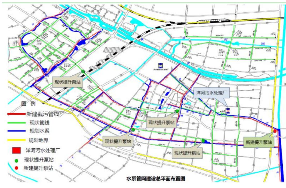
图 8.3-1 项目水系管网建设总平面布局图
