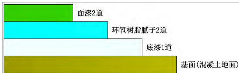
图 6.4-1 环氧地坪结构示意图
